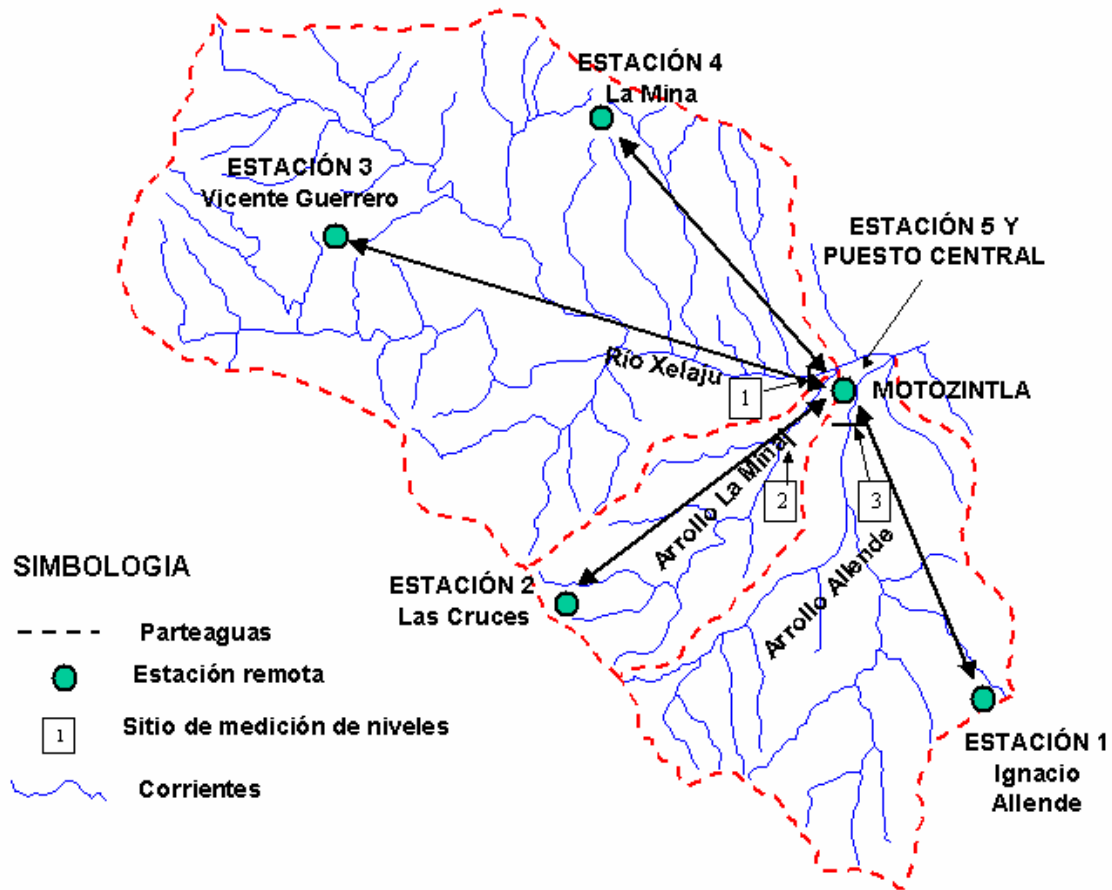
Figura 4.3 Localización de estaciones y topología del Sistema de Alerta Hidrometeorológica de Motozintla
