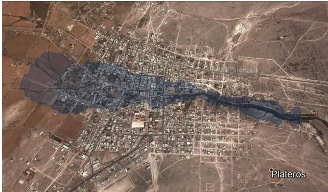
Figura 4-40 Polígono de Inundación asociado a un periodo de retorno de 2000 años, de la localidad de Plateros.
