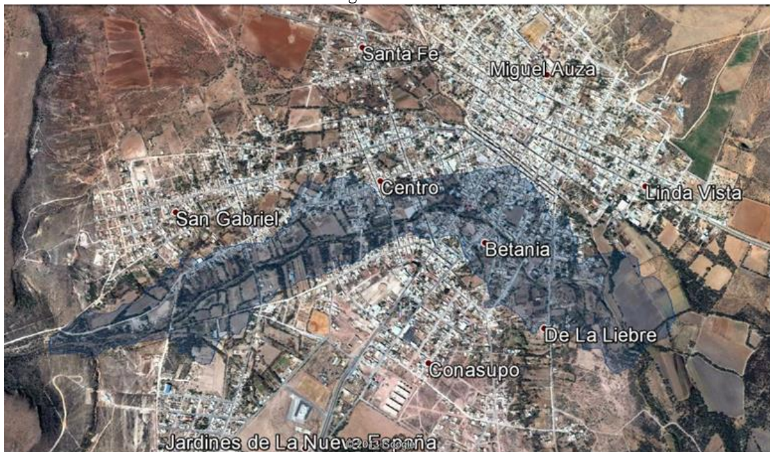
Figura 4-37 Polígono de Inundación asociado a un periodo de retorno de 2000 años, de la localidad de Miguel Auza
